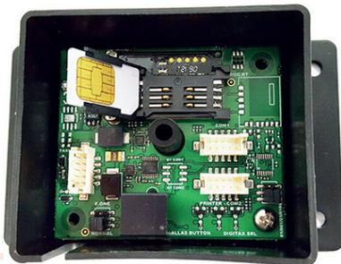
Alle Digitax Taxameter und Datenterminals mit MID- Zulassung ( ab 2007 ) können mit diesem TIM Kartenleser nachgerüstet werden. Die Signierung der Daten wird durch die Firmware der Geräte gesteuert. ( ggf. Update erforderlich )
